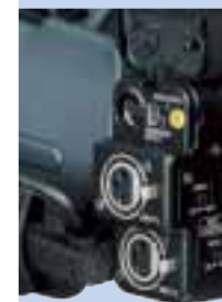
Microfono stereofonico incorporato e ingresso audio XLR a 2 canali
